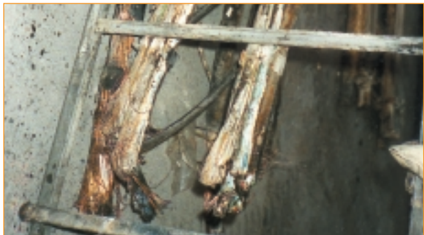
Halogenfreie Kabel nach dem Abbrand Non-halogenated cables after the fire
