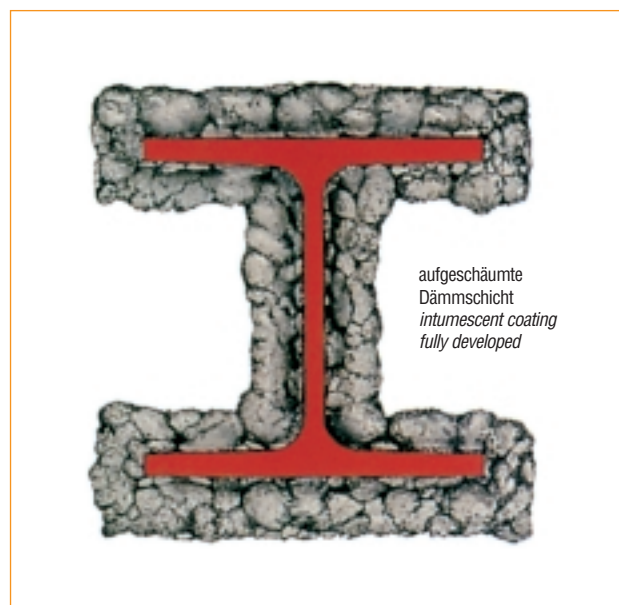
Träger nach Brandeinwirkung protected steel beam after a fire
